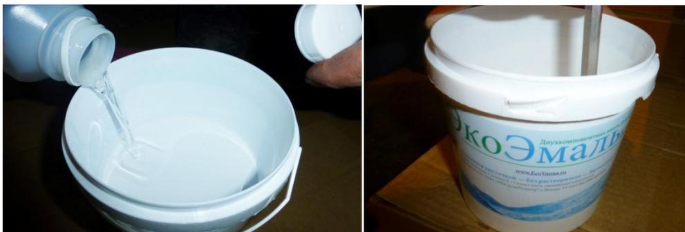
Перед смешиванием основы и отвердителя, перемешайте основу в течение 5 минут. Начините вливать отвердитель, продолжая перемешивание. После смешивания компонентов, продолжайте тщательное перемешивание в течение 7 минут. Не используйте для перемешивания дрель - это вызовет излишнее попадание воздуха в материал. После перемешивания, дайте материалу настояться в течение 5-7 минут.
